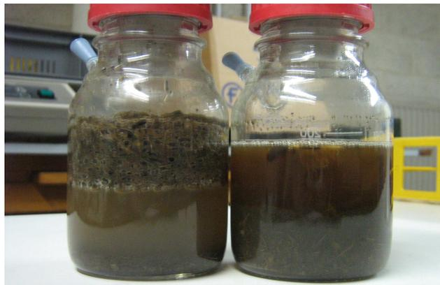
**Figure 8.6** Différence de présentation entre digestats digérés par le *Ps7* (à droite) et les contrôles non digérés (à gauche) dans la liqueur mixte
