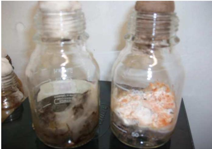
**Figure 8.7** Comparaison entre le développement des moisissures blanchâtres endogènes (gauche) et le Ps7 (droite) dans les digestats de maïs.
