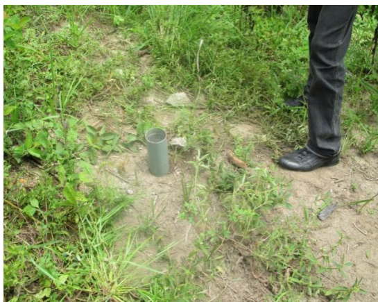
Fig.5 : Essai de perméabilité de sol in situ au site du Mont-Amba
