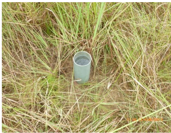
Fig.6 : Essai de perméabilité de sol in situ à Mont-Ngafula
